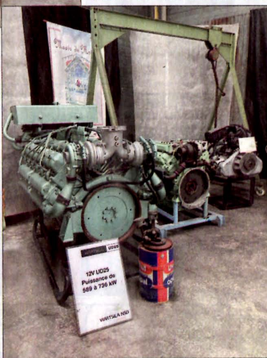
◀ Un autre géant du musée, ce Wartsilä UD25 est un générateur diesel de 589 à 736 mw. La marque finlandaise a racheté SACM en Alsace, et Poyaud à Surgères, non loin de Saumur.
