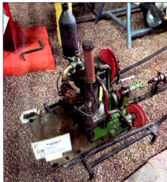
▲ Le 204 e moteur De Dion construit. Ce petit monocylindre 211 cm 3 de 1897 est à 4-temps. Il était destiné à la propulsion marine.
