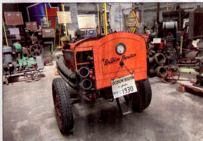
▲ Robustes et fiable, les moteurs De Dion ont eu une très longue carrière comme motopompes au service de la protection incendie.
